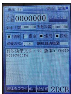
图 2-4 连接 HC-PM51-V6，选择存储位置“10”，点击“下载 hcf”按钮，显示下载成功
