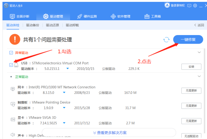
圖 3.2-2 勾選異常驅動“STMICROELECTRONICS Virtual COM Port”，點擊“一鍵修復”按鈕
