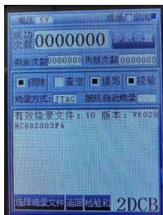
圖 2-4 連接 HC-PM51-V6，選擇存儲位置“10”，點擊“下載 hcf”按鈕，顯示下載成功
